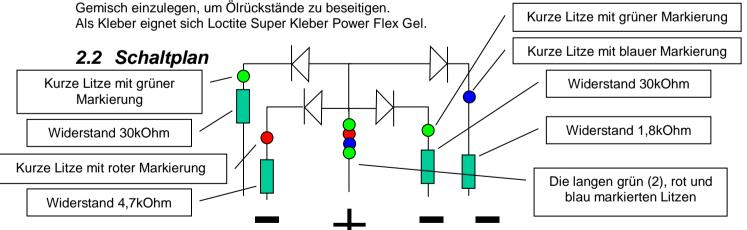
**OPTIONAL:** die LEDs für das Vorsignal werden in gleicher Weise angeschlossen. Die warmweiße unmarkierte LED für den Geschwindigkeitsanzeiger ebenso. Die weiße LED wird mit einem 1,8kOhm Widerstand angeschlossen. Die weißen LEDs sind an der gelblichen Vorderseite erkennbar.
