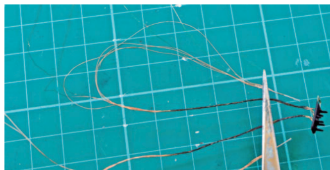
Die Lackdrähte werden auf gute Mastlänge zu zwei Bündeln zusammengedreht. Der Längenausgleich erfolgt durch provisorische Schlaufen vor den verdrehten Enden
