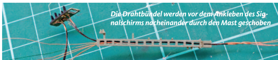
Die Lackdrähte werden auf gute Mastlänge zu zwei Bündeln zusammengedreht. Der Längenausgleich erfolgt durch provisorische Schlaufen vor den verdrehten Enden
