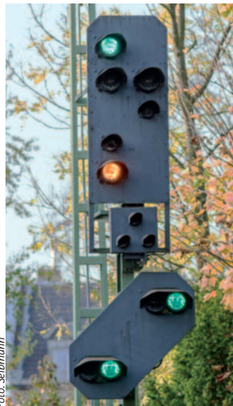
Mattschwarzer Schirm der Signalbauart 69 mit seinen typischen Signaloptikfarben in bläulichem Grün und Orangegelb
